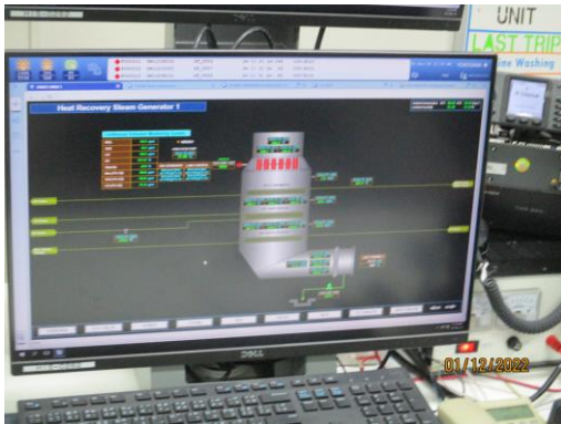
รูปที่ 5 ระบบควบคุม NO x
